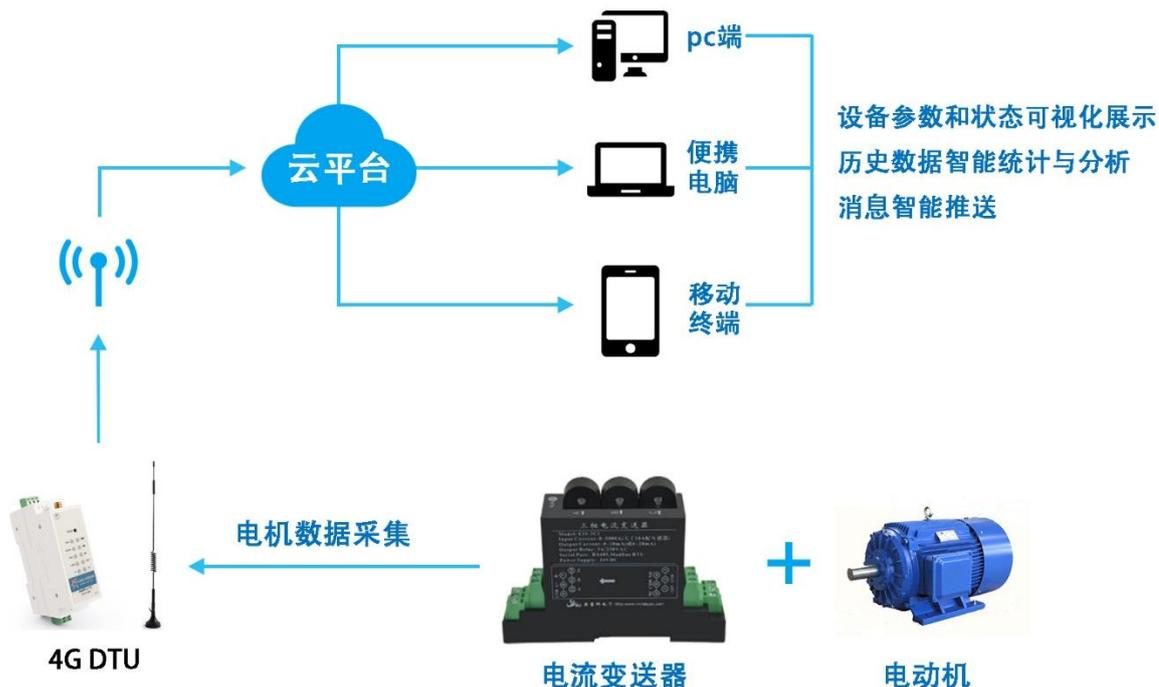
图 1 电流变送器系统网络拓扑图
