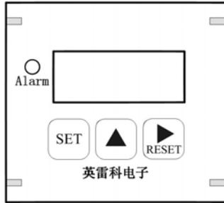
Alarm 为过电压输出继电器动作状态指示灯，窗口显示被测电压值。
